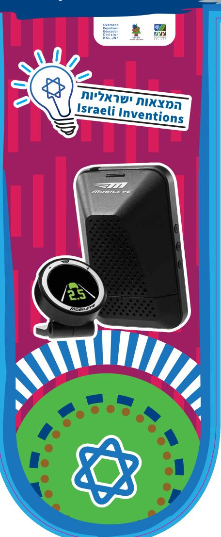
מערכת מובילאיי, שיש בה מצלמה אחת בלבד, מתריעה בזמן אמת מפני מגוון סכנות, כגון סכנת התנגשות וסטיית הרכב מנתיב הנסיעה. המערכת אף מזהה הולכי רגל, רוכבי אופניים ואופנועים בסביבת הרכב וכן תמרורי מהירות. למעשה, המצלמה משמשת כמעין "עין שלישית" עבור הנהג, והפונקציות של המערכת מסייעות במניעת תאונות דרכים ומהוות תשתית לפיתוח רכב אוטונומי. מובילאיי הוקמה בישראל, בשנת 1999, על ידי פרופסור אמנון שעשוע וזיו אבירם. חברה זו היא חלוצה ומובילה בתחומה.
